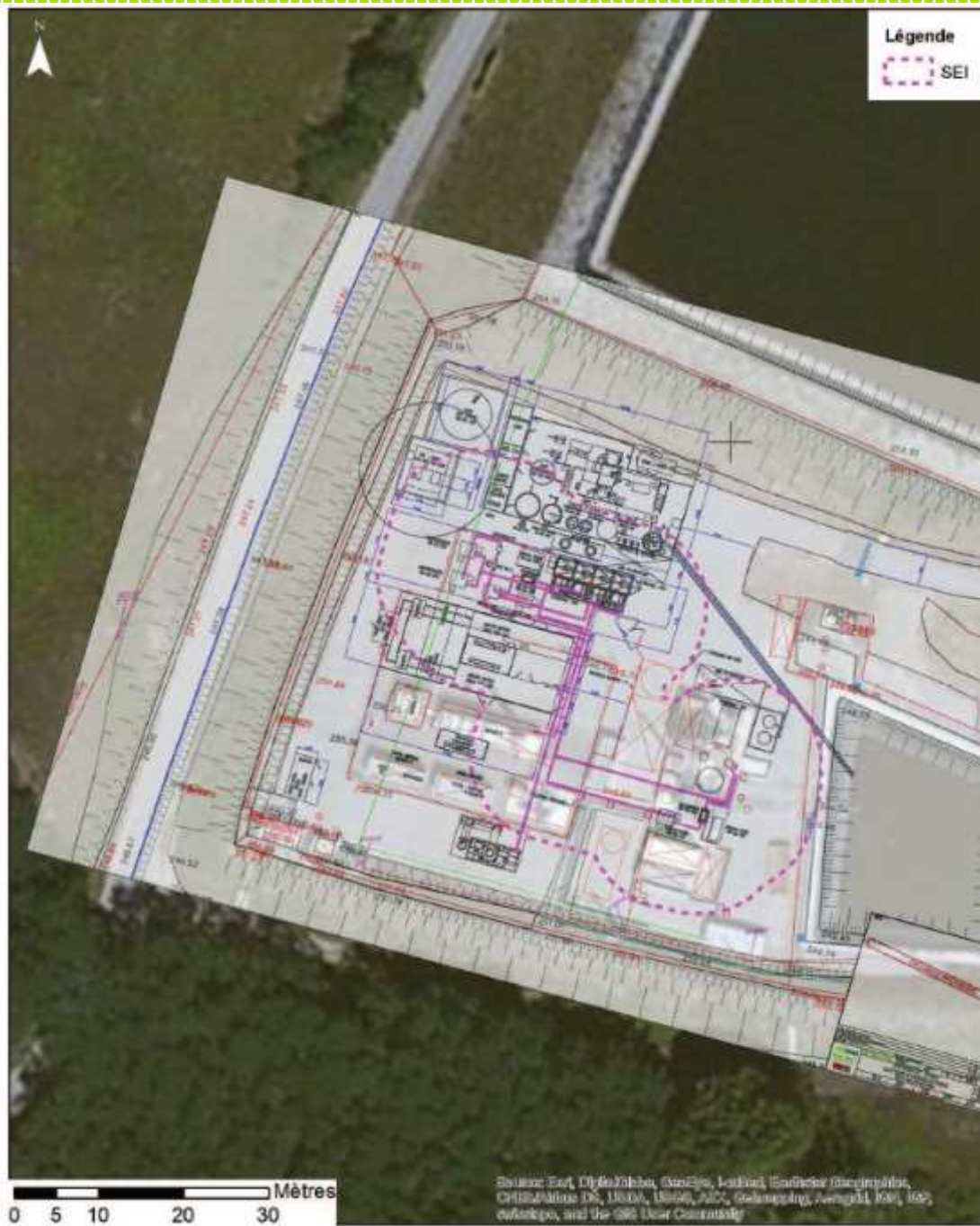
Figure 19 : PhD3 - cartographie des effets toxiques d'une dispersion toxique d'H 2 S résultant de la rupture franche de la plus grosse tuyauterie au niveau de l'unité de valorisation du biogaz
